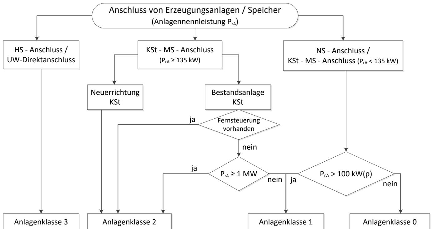
**Bild 1** Klassifizierung von EZA zur technischen Umsetzung des Wirk- und Blindleistungsmanagements
