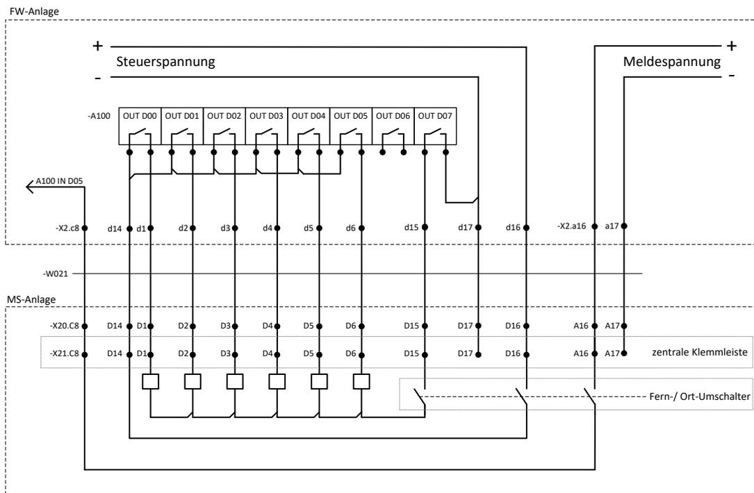
**Bild A.3.1 – 1,5-polige Steuerung**
