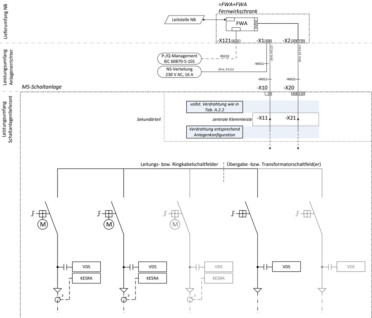
**Bild 1 – Schematischer Aufbau und Anbindung MS-Schaltanlage und Fernwirschrank**
