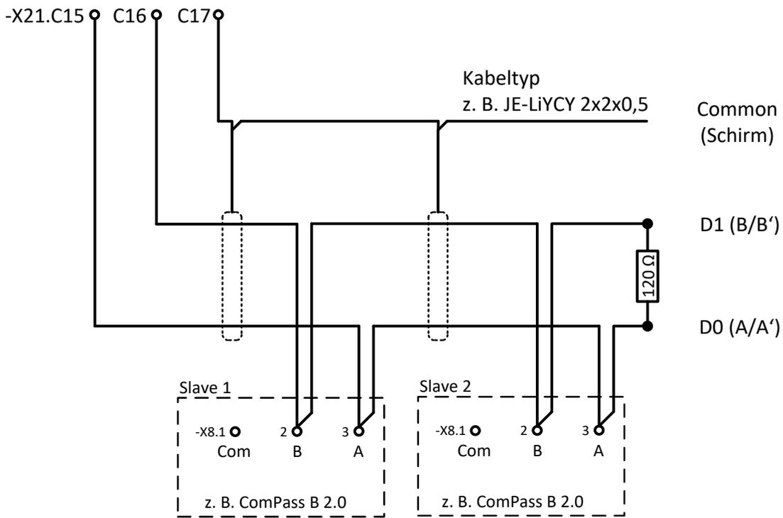
**Bild A.3.3 – Anschlussschema für serielle Datenübertragung, Variante 1**
