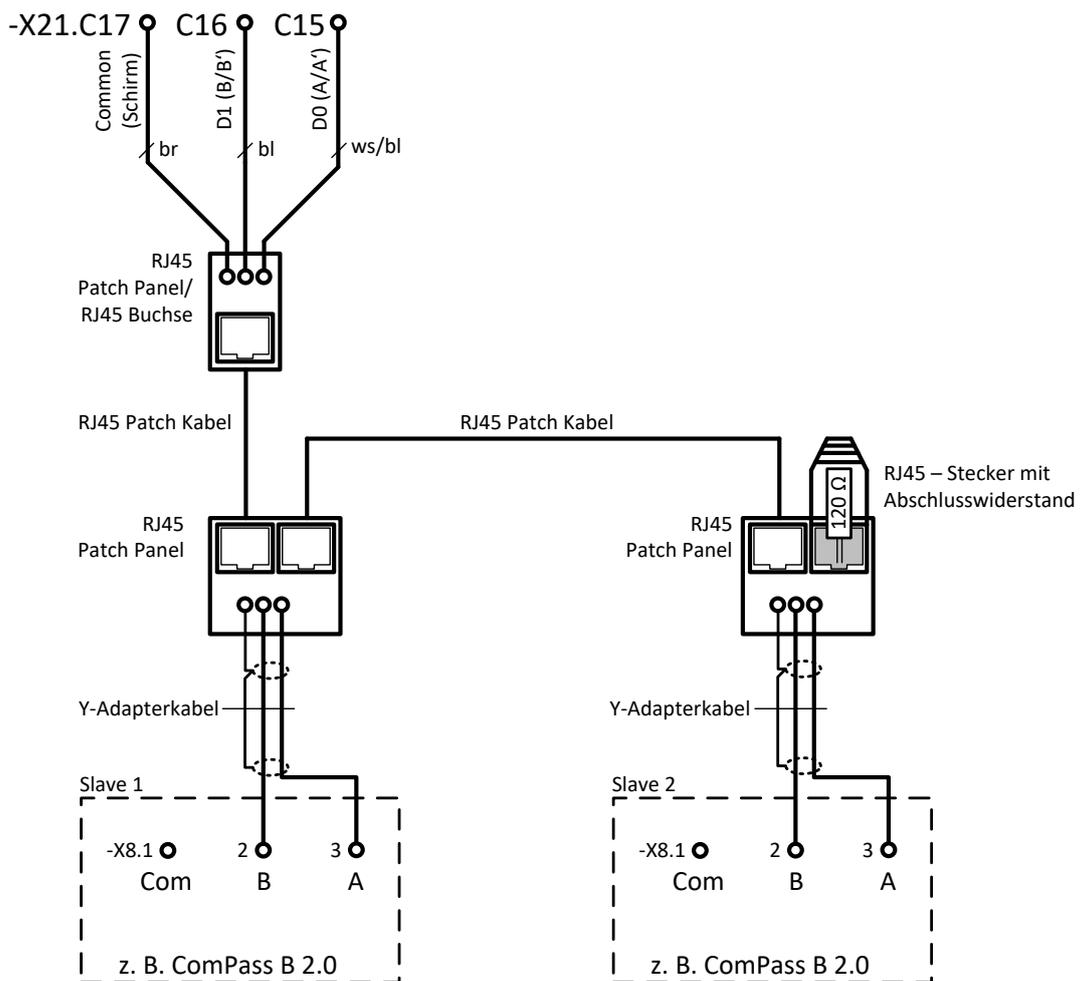
**Bild A.3.4 – Anschlussschema für serielle Datenübertragung, Variante 2**
